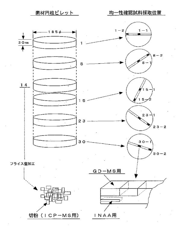
図 - 1 均質性試験用試料採取位置
