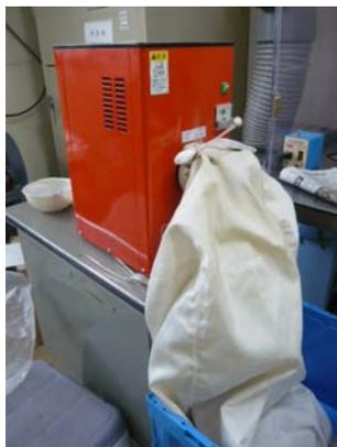
写真 12：炉布取り付け
