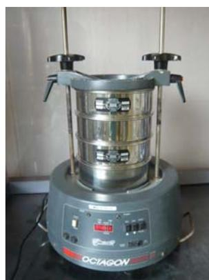
写真 14：電磁振動篩い分け器
