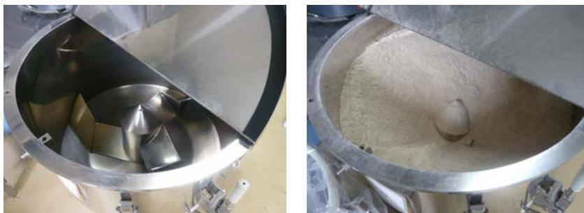
写真 5 : 攪翼式混合機
