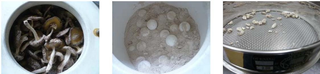
写真6：左-試料投入時 300g、中-60分粉碎後、右-分級後 2mm 篩上
