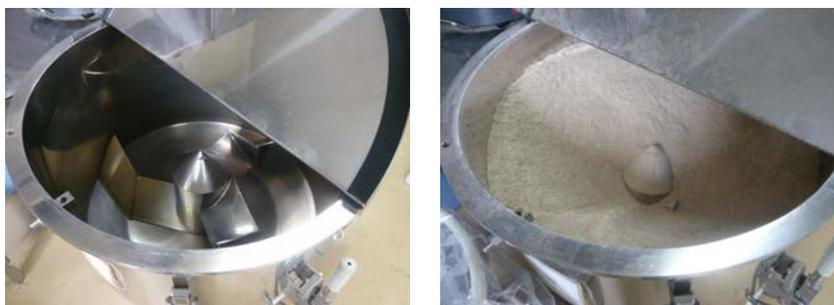
写真 15：攪翼式混合機
