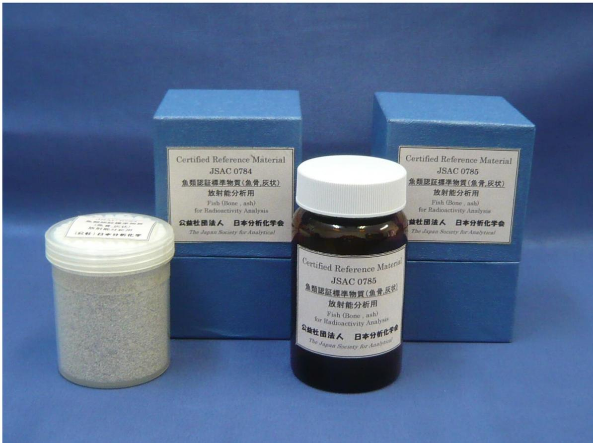
写真2 開発した放射能分析用魚類認証標準物質（魚骨、灰状）（JSAC 0784 及び JSAC 0785）
