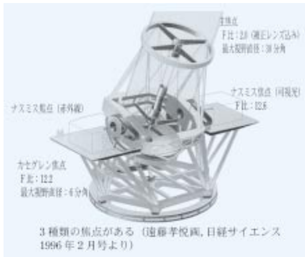
図1 イラスト：すばる望遠鏡の仕組み
