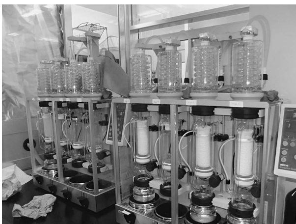
写真3 自動ソックスレー抽出装置によるダイオキシン類の抽出
