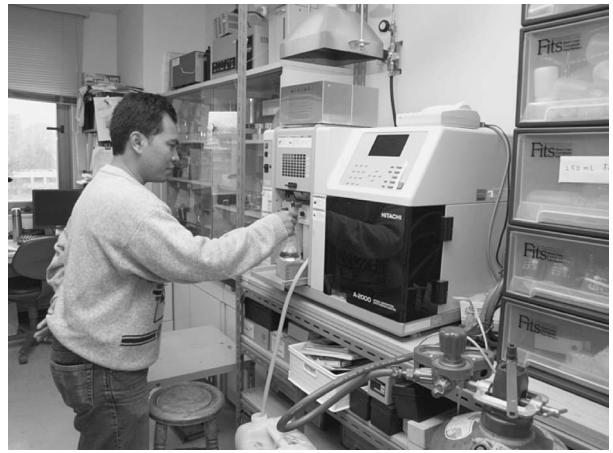
写真3 原子吸光分析装置を用いた測定の様子
